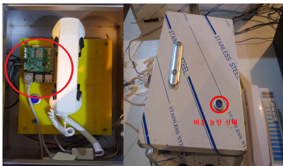
그림 16. 공유기 연결 상태에서 방송 테스트 Fig. 16. Broadcast test with modem connected
