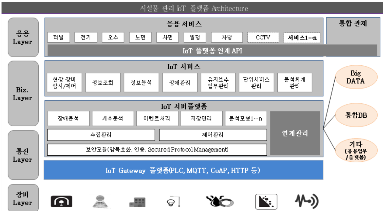
그림 10. 센싱 장비 기반 IoT 플랫폼 사례 Fig. 10. IoT platform based on sensing equipment (ex)
