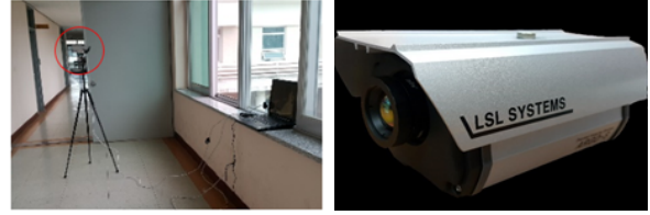
그림 4. 실험 환경 세팅, (a) 열화상 카메라 촬영 환경, (b) LSL 시스템즈의 Argo-S 열화상 카메라
