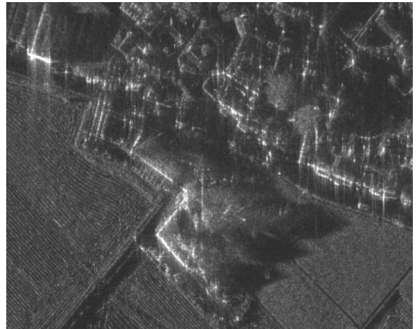
그림 6. 제안한 방법 결과 Fig. 6. SAR image with proposed PGA
