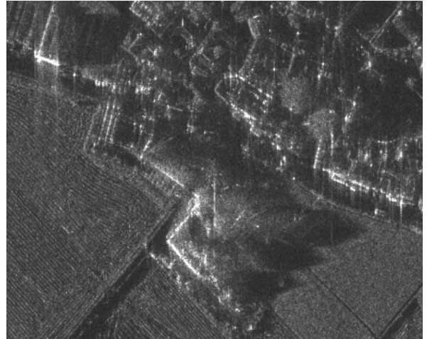
그림 5. 일반적인 PGA 결과 Fig. 5. SAR image with general PGA
