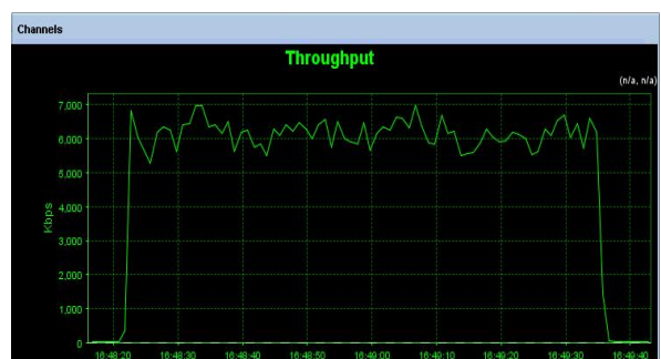
그림 7. 50Mbyte 전송 시간 측정(네트워크 변경 후) Fig. 7. Measurement of 50Mbyte transmission time (After changing the network)
