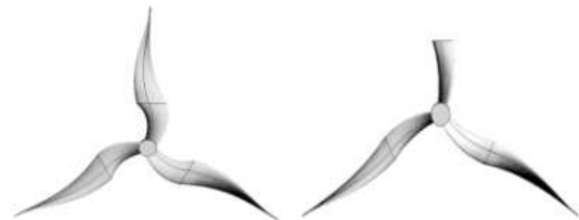
(a) 정상적인 표적 (a) Normal target (b) 파손된 표적 (b) Broken target
