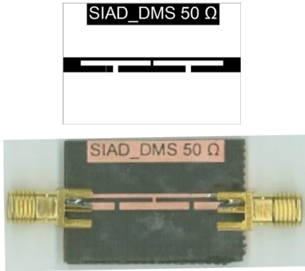
그림 6. 기판집적 가유전체 구조와 결합 마이크로스트립 구조가 함께 사용된 50Ω 전송선로의 레이아웃과 제작 사진 Fig. 6. Layout and photo of the fabricated 50Ω SIAD-DMS microstrip line
