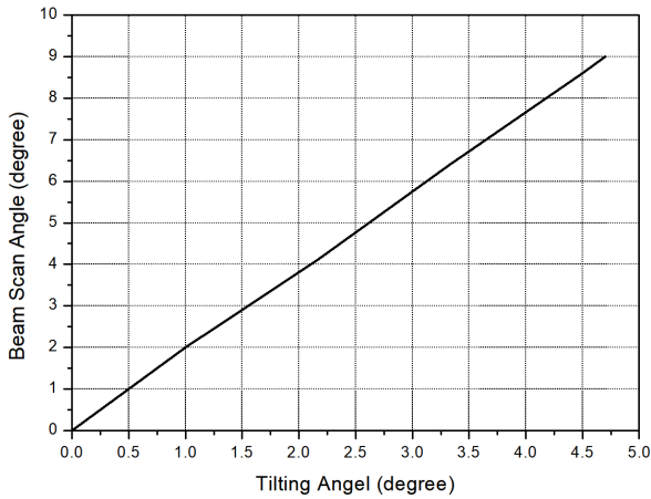
그림 8. 주 반사판의 기울임 각도에 따른 빔 조향 각도 Fig. 8. Beam scanning angle according to tilting angle of main reflector
