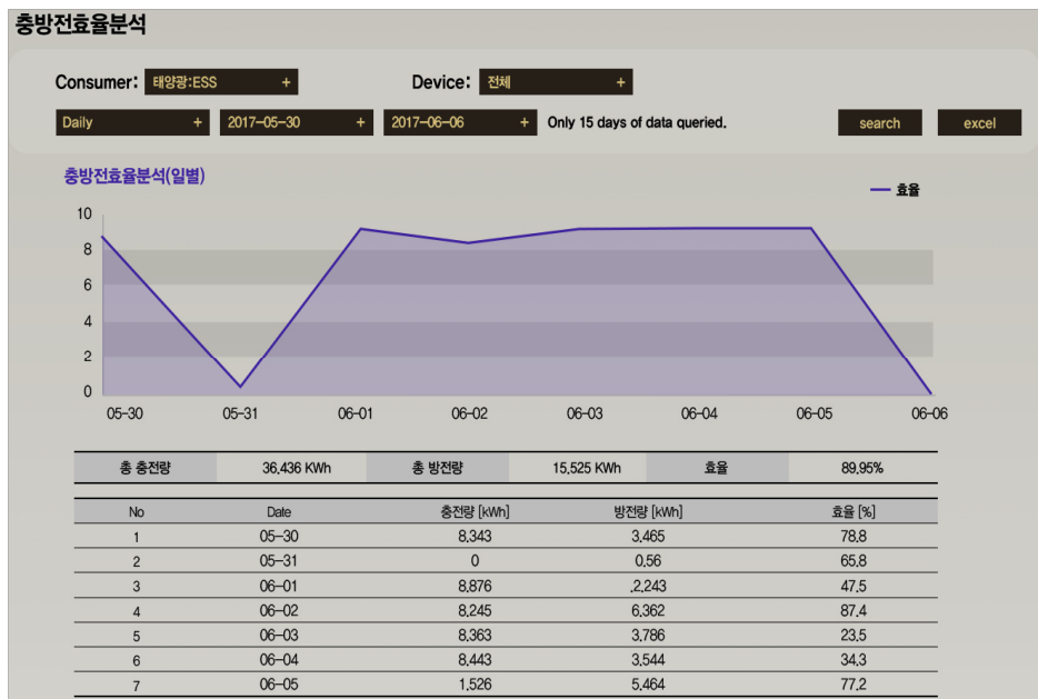
그림 5. 충/방전량에 따른 효율 분석 Fig. 5. Efficiency analysis according to amount of charge and discharge
