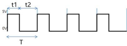
그림 5. 듀티비 Fig. 5. Duty ratio
