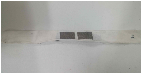
그림 3. 제작된 손목형 ECG 섬유 Fig. 3. Manufactured wrist ECG fiber
