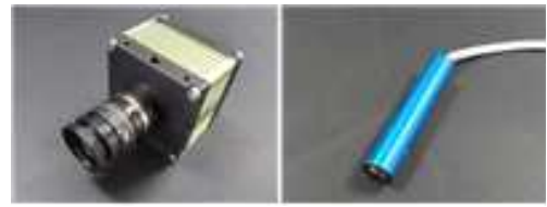
그림 10. 카메라와 라인 레이저 모듈 Fig. 10. Camera and line laser module
