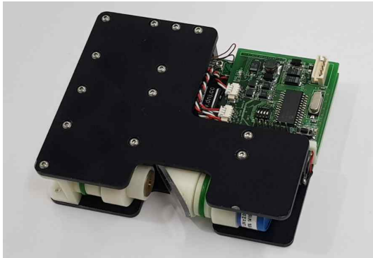
그림 8. 제안한 방법을 구현한 레이저 투사장치 Fig. 8. Laser projector implementing the proposed method
