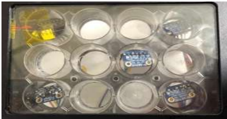
그림 9. 아두이노 센서가 장착된 웰 플레이트 Fig. 9. Well plate with arduino sensor
