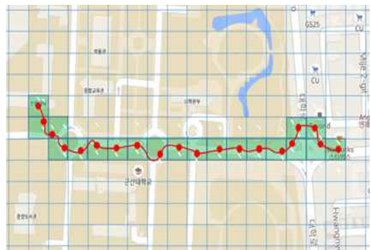
그림 4. 격자 기반 경로 표현방법 예 Fig. 4. An example of grid-based path prediction
