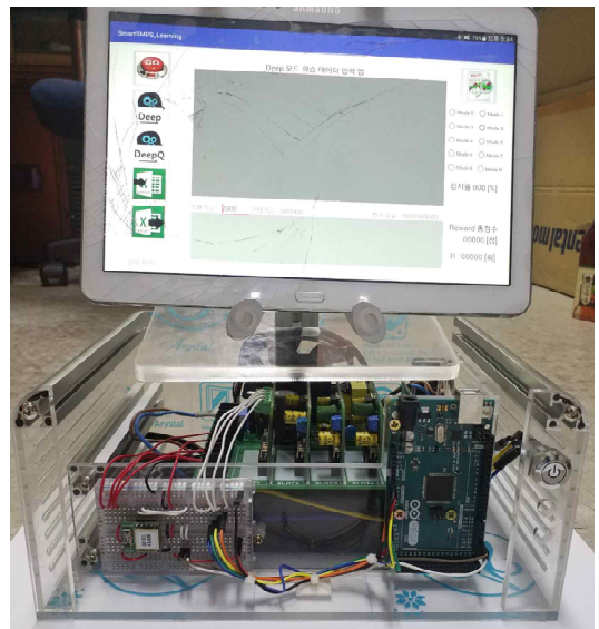
그림 6. 스마트 플러그인 스위칭 모드 전원장치 Fig. 6. Smart plug-in SMPS
