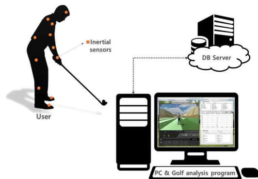
그림 1. 제안한 골프 모션 분석 시스템 Fig. 1. Proposed golf motion analysis system
