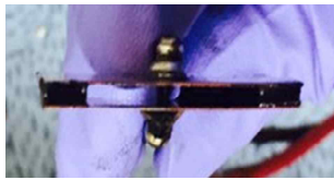
그림 2. 평행 평판 전극형 센서 Fig. 2. Parallel plate electrode type sensor
