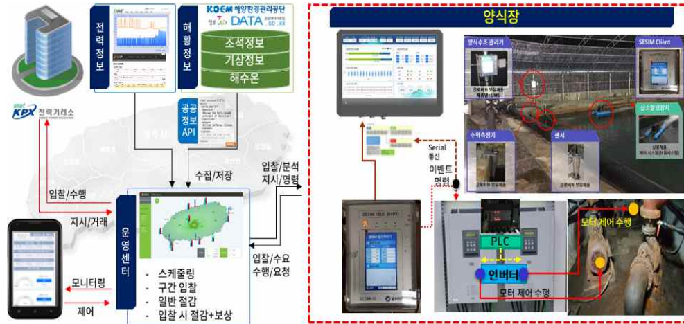
그림 5. 양식장 OpenADR 2.0b 기반의 수요반응 서버 프레임워크 및 시스템 구성도 Fig. 5. DR server framework & system architecture based on OpenADR 2.0b for aquaculture
